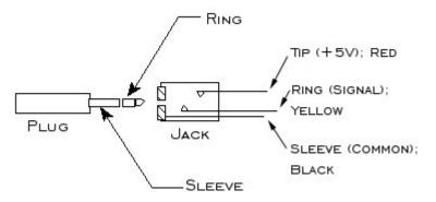
THE PLUG IS A STANDARD 2.5MM STEREO (TRS) PLUG. THE SUPPLIED JACK IS FULLY INSULATED FROM THE MOUNTING HOLE. OTHER 2.5MM JACKS MAY BE SUBSTITUTED - BUT MAKE SURE THAT THERE IS NO GROUND PATH BETWEEN THE COMMON TO ANY OF THE POWER INPUTS (P1:1 AND P1:2).
